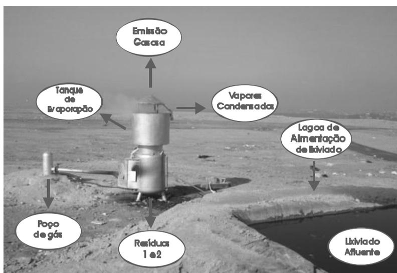
Figura 1. Evaporador Unitário em funcionamento no aterro
